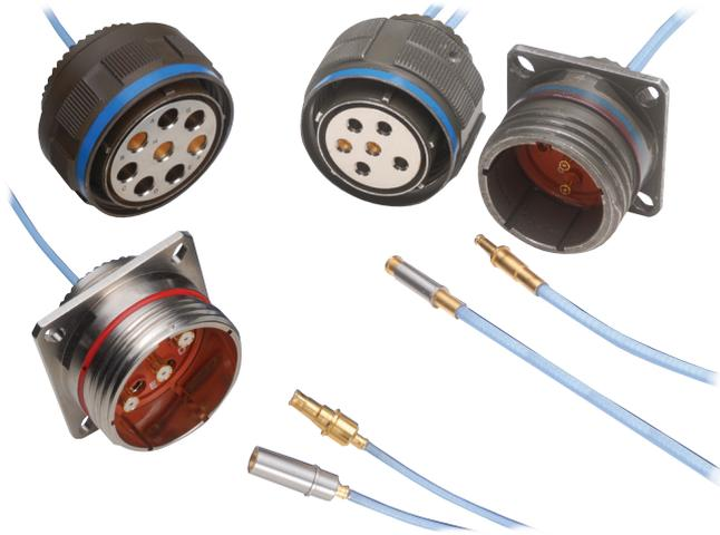
Smiths Interconnect의 고주파 동축 단자(MHC)는 다중핀 커넥터에 적용 시 8사이즈의 경우 최대 26.5 GHz의, 12사이즈의 경우 최대 40 GHz의 우수한 RF 성능을 제공합니다. “플로팅 마운팅” 방식으로 설계된 이 단자는 결합 인터페이스에서 에어갭(air gap)을 방지함으로써 극초단파 주파수에서 낮은 VSWR을 보장합니다. 해당 단자는 말단 부분이 직경 0.086의 유연 케이블(RG-405와 동일)로 구성됩니다.
